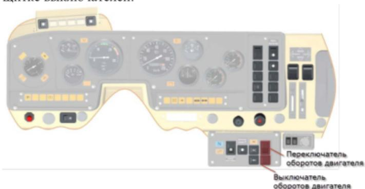
**Включение режима регулировки** Для включения режима регулировки следует нажать и удерживать выключатель оборотов в течение 5 секунд.
